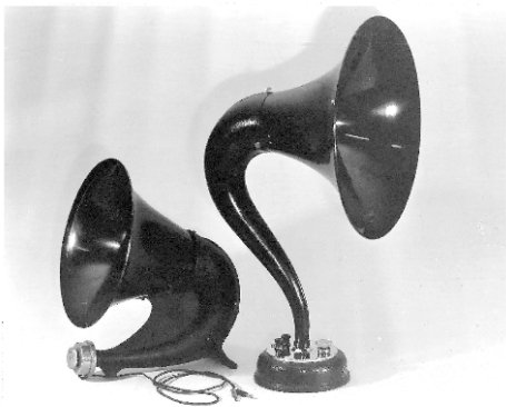
Der Trichterlautsprecher in seinen zwei bekanntesten Ausführungsformen (1925/26)
