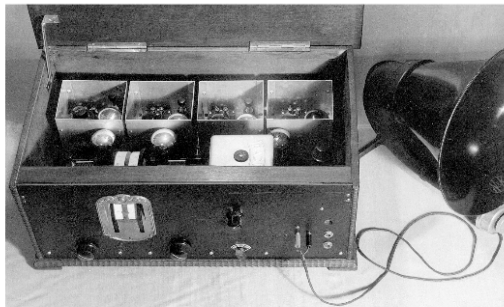
Siebenröhren-Super für Batteriebetrieb (Radix, 1928) : hohe Empfangsleistung, trotzdem einfache Bedienung
