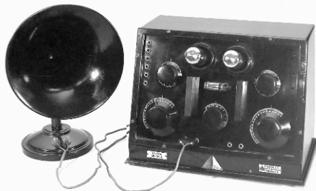
Typischer Zweiröhren-Empfänger 1925/26 (Firma Mende, Type E 35). Die vielen zu bedienenden Knöpfe erschwerten den Gebrauch der Geräte.
