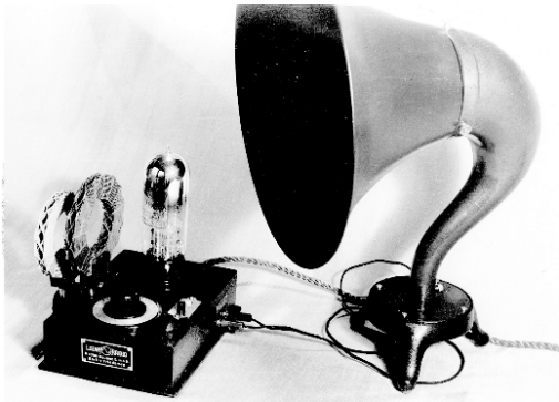
Loewe-Ortsempfänger Type OE 333 mit der legendären Dreifachröhre, an deren Entwicklung Manfred von Ardenne maßgeblichen Anteil hatte.
