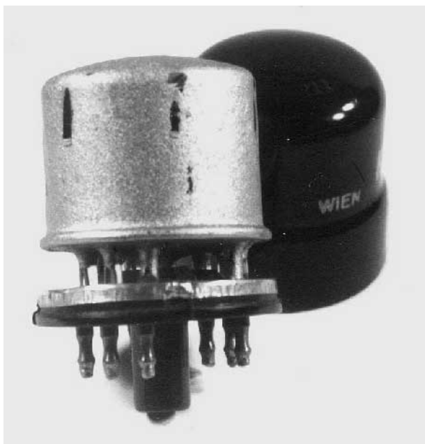
Glas-(Stahl-)Röhre von Tungram-Wien, frühe Version (1939), Metallhaube abgehoben.
