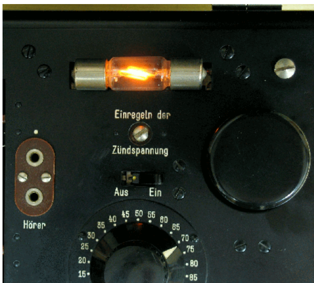
Bild 3: Zündung der Glimmlampe als Eichkontrolle.
