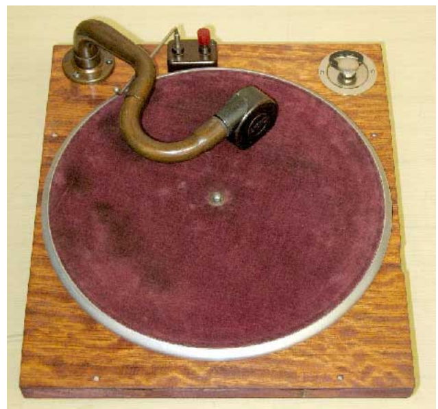
Bild 16: neue Plattenspieler-Grundplatte einbaufertig, vgl. mit Bild 2
