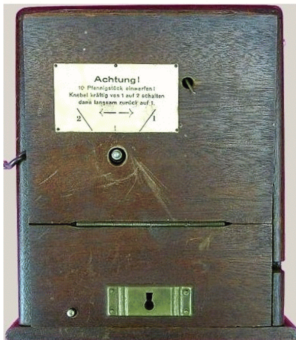
Bild 29: Rückansicht mit Handlungsanweisung, der Schaltknebel fehlt leider
