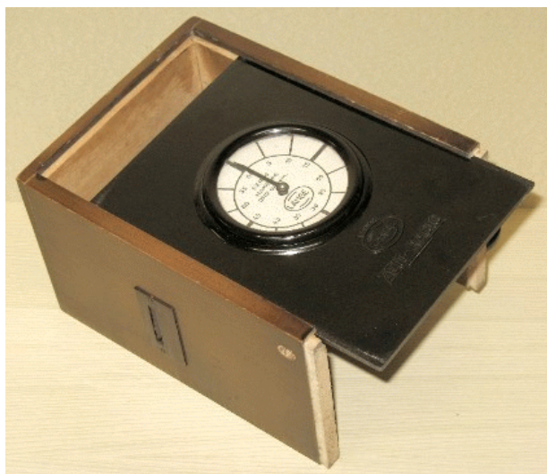
Bild 37: Herausziehen der Frontplatte
