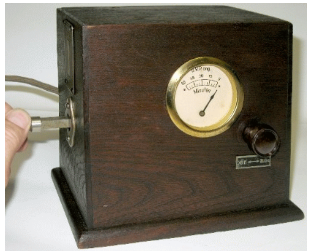
Bild 59: Aufziehen mittels Schubstange
