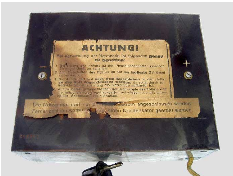
Bild 10: Frühe Version der BNA 36 nur für Wechselstrom
