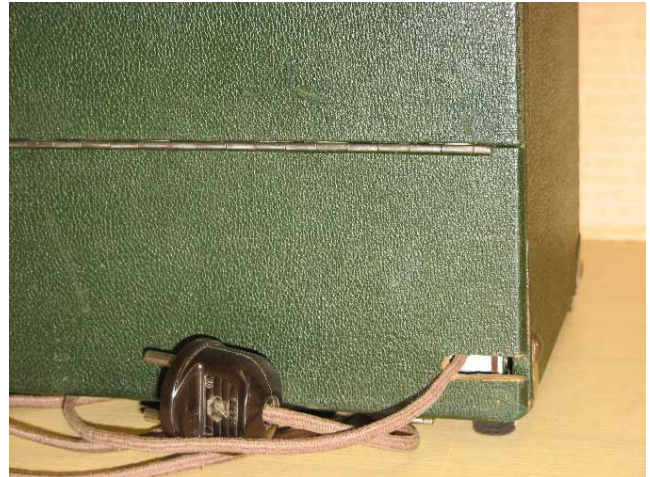
Bild 5: eingesägter Schlitz für die Netzschnur
