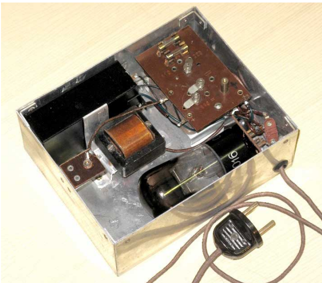
Bild 7: Innenansicht der Netzanode B.N.A. 36
