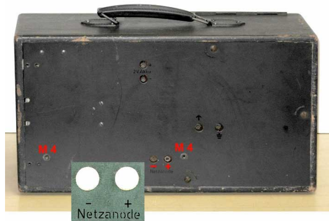
Bild 43: ER 3 auf Netzanode vorbereitet
